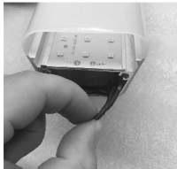
5: Tenez le câble de la batterie et sortez-le du néon avec précaution jusqu'à voir les connecteurs CC.
