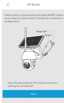
4. Pressez le bouton reset pendant 5 secondes sur le bouton dissimulé sous un capuchon d'un des câbles extérieurs. Après environ 10 secondes, l'appareil se met en mode configuration: «wait for configuration». Cliquez alors sur «Une étape suivante».
